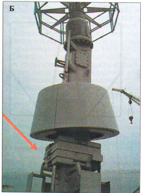
КВ-антенна МССР: А – внешний вид; Б – смонтированная на мачте эсминца «Рузвельт» (DDG 80)
