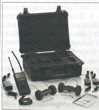
Дистанционно управляемый аппарат Recon Scout (справа – комплект в переносном кейсе)
