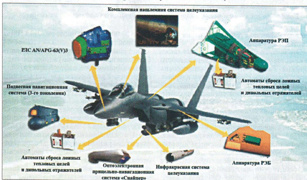
Основные элементы бортового оборудования истребителя F-15SE
