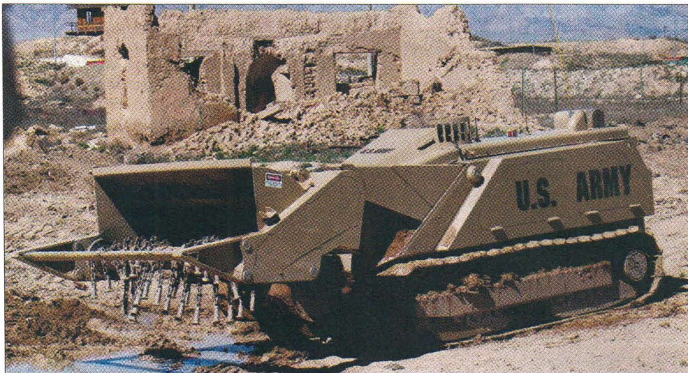
Безэкипажная машина разминирования MV-4, развернутая в Афганистане (вверху) и в ходе подрыва самодельного взрывного устройства
