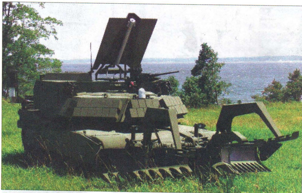
Инженерная ДУМ АВВ (слева – в ходе обследования бережья на наличие мин перед десантированием основных сил)
