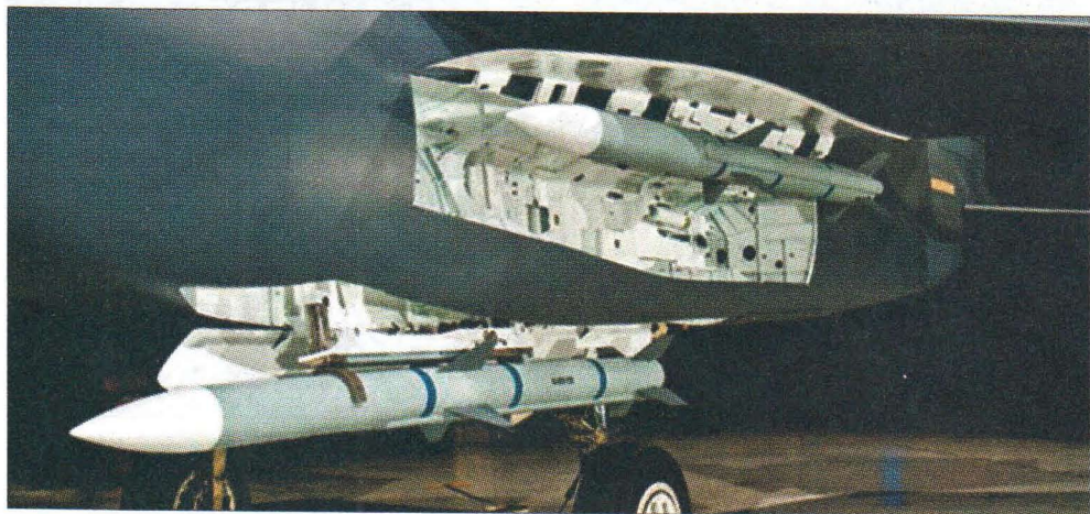
Боковой и нижний отсеки вооружения в конформных контейнерах самолета F-15SE
